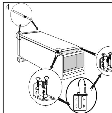
5. Возможный зазор следует удалить посредством регулирования высоты нижней петли прикладываемым к холодильнику регулировочным ключом. Зафиксируйте положение двери контргайкой. Установите вентиляционную решётку обратно на место.
